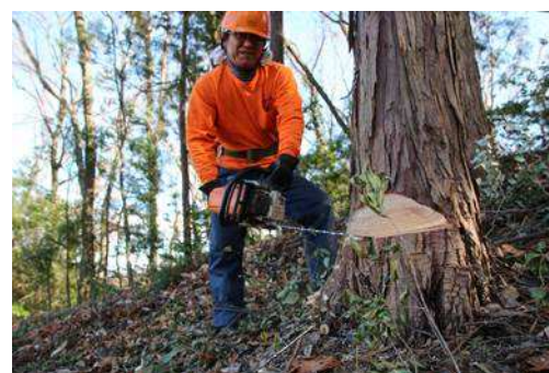
木を倒す方向の根元に切り込みをいれて倒しやすくします（受け口）
