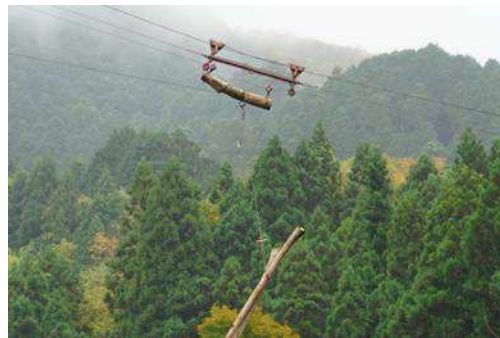
急傾斜地や路網未整備の森林で、距離にして1000m超の集材ができる「架線集材」
