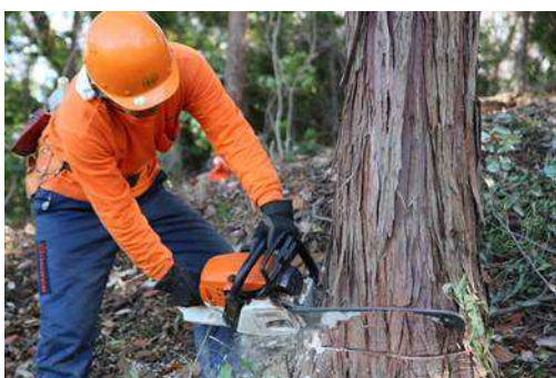
木を倒す方向の根元に切り込みをいれて倒しやすくします（受け口）
